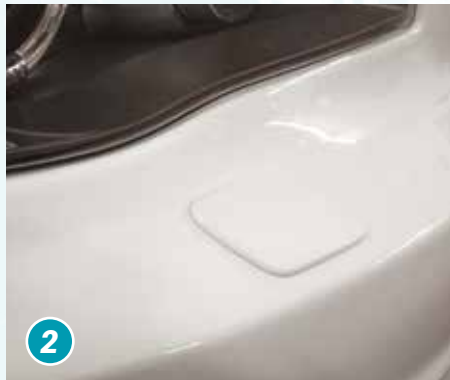
Flache Ausführung der Waschanlage
