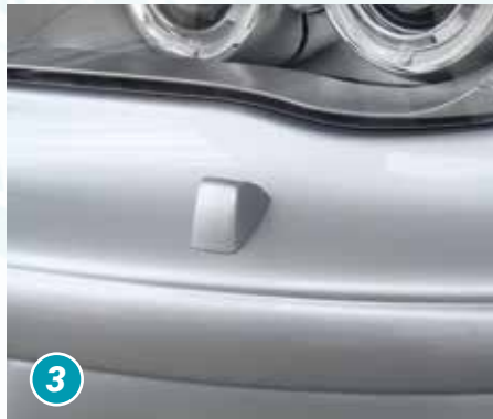
Hohe Ausführung der Waschanlage
