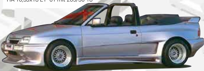
Nebelscheinwerfer und Blinkleuchten org. VW Corrado VR6
